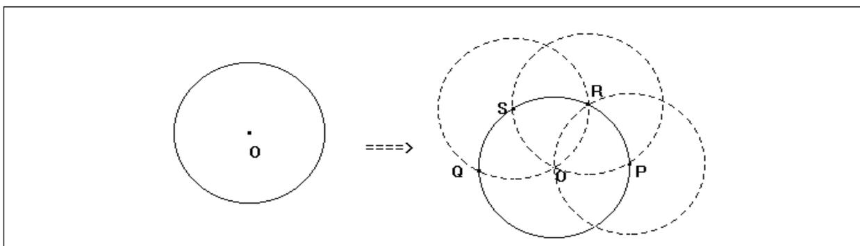
Figura a.5 – Construção de uma circunferência e um diâmetro (2)
