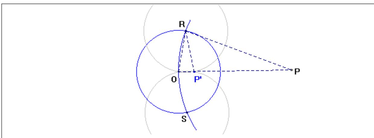
Figura 1.14 – Construção de pontos inversos.
