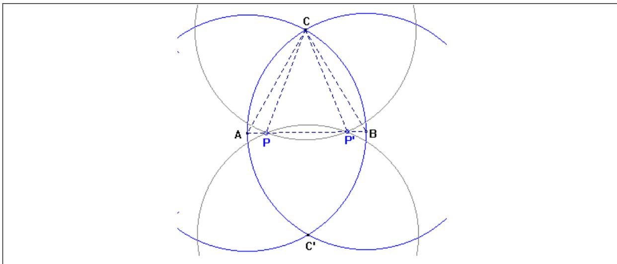
Figura a.19 – Construção de pontos colineares com A e B.
