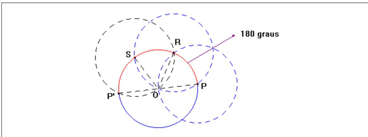
Figura a.17 – Construção de um ângulo raso (com o compasso apenas).
