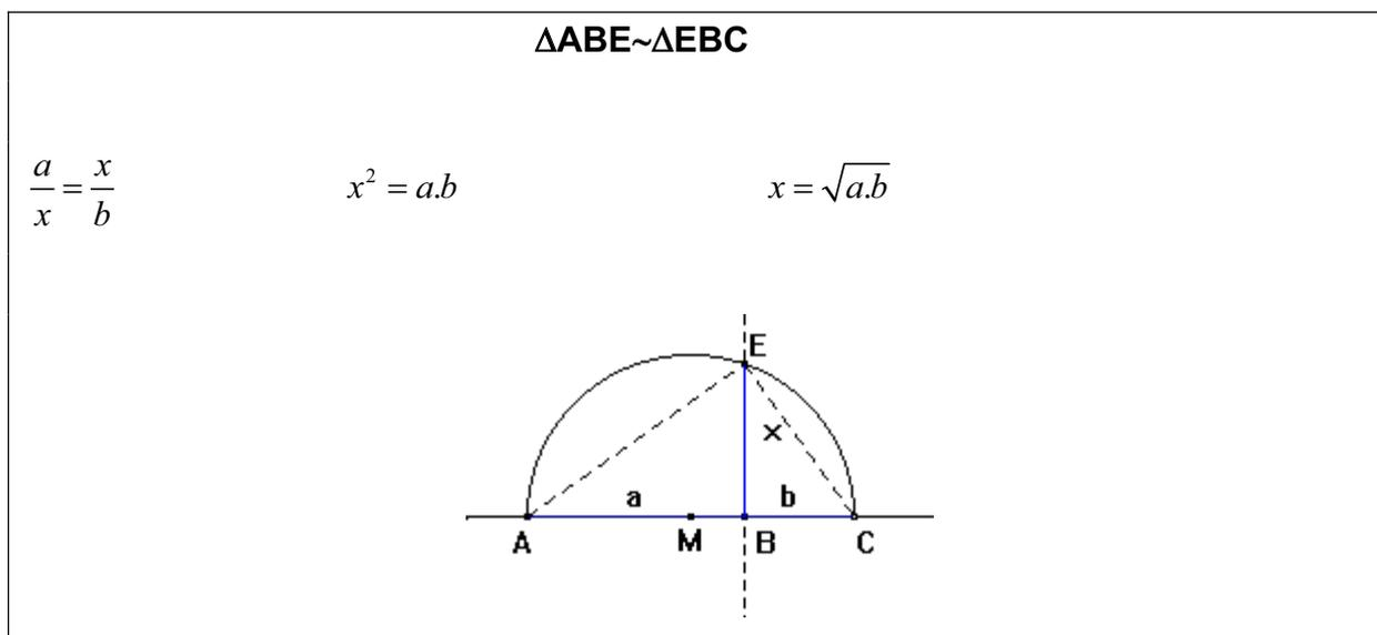
Figura 1.5 – Construção da média geométrica entre  $a$  e  $b$
