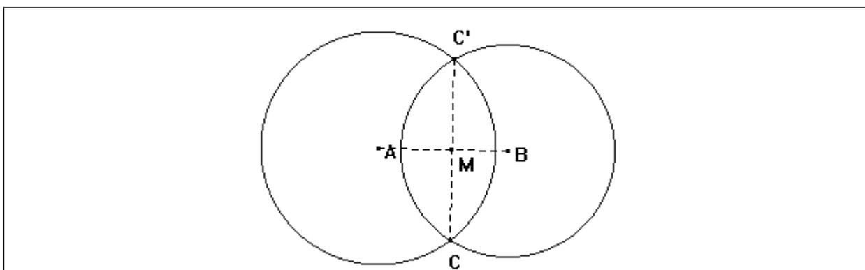
Figura 1.6 – Construção do simétrico de um ponto; simetria axial.
