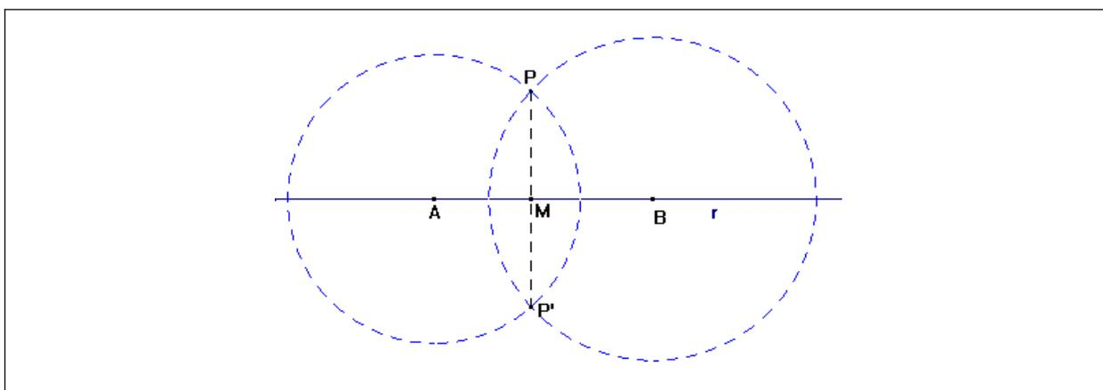
Figura a.12– Simetria axial (com o compasso apenas).
