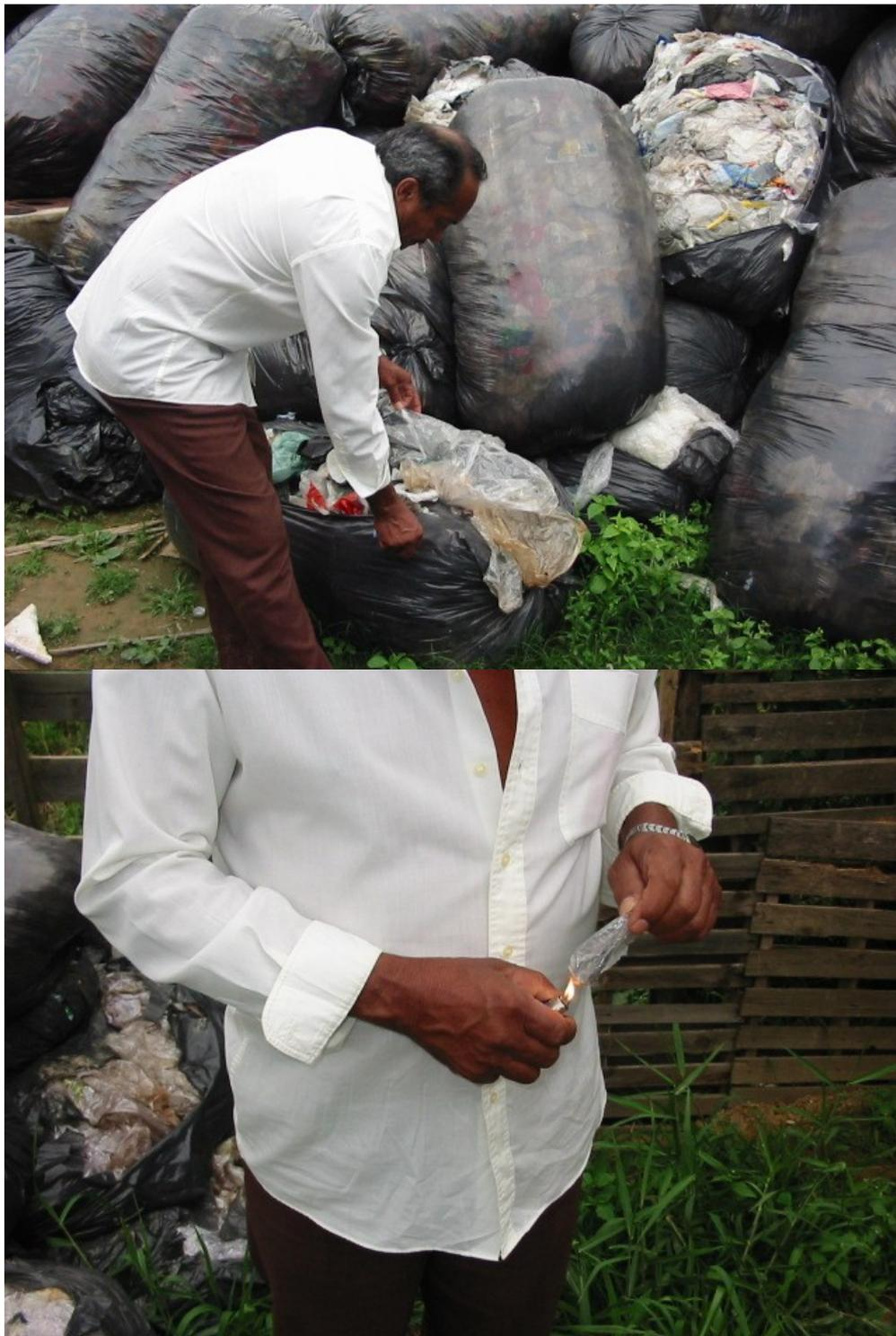
Fotos 13 e 14: Romualdo mostra o material triado. Ele queima o plástico para identificar através do cheiro seu tipo.
