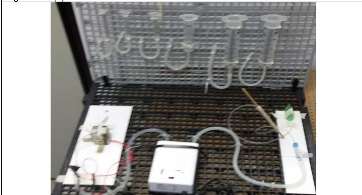
Figura 5.13 (b) - bolhometro interligado ao sistema
